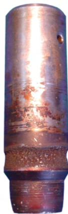
Rys. 5. Uszkodzenie grzyba zaworu w wyniku kawitacji
