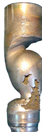
Rys. 6. Uszkodzenie grzyba zaworu w wyniku flashingu
