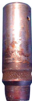
Rys. 5. Uszkodzenie grzyba zaworu w wyniku kawitacji
