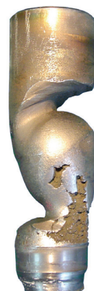
Rys. 6. Uszkodzenie grzyba zaworu w wyniku flashingu
